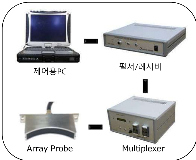
Array Probe용 검사시스템 구성 한 예
