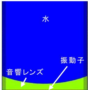
図4 音響レンズシミュレーションモデル
