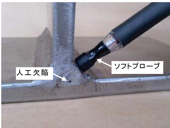
図 8 ソフトプローブによる隅肉溶接部探傷
