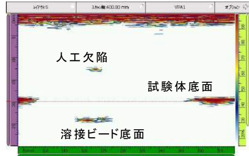
図 13 フレキシブルリニアアレイプローブによるパイプ溶接部断面画像
