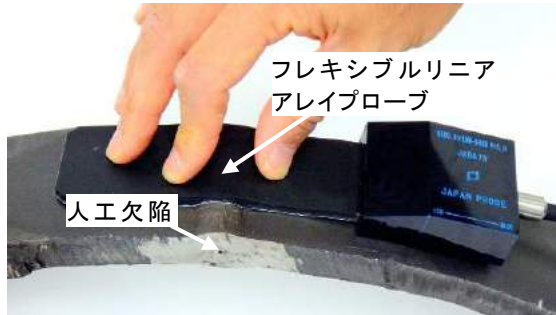
図 12 フレキシブルリニアアレイプローブによるパイプ溶接部探傷
