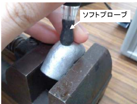
図 10 ソフトプローブによる パイプエルボ部計測
