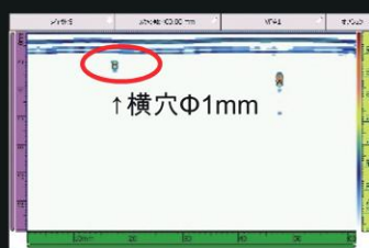
鋼表面下1.5mmΦ1mm 欠陥検出例
