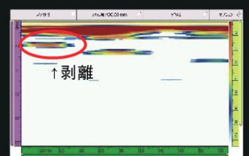
CFRP表面下2mm 剥離検出例
