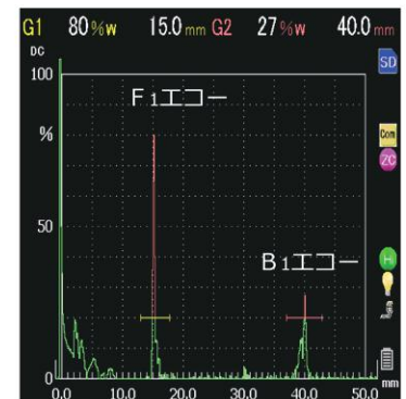
半球試験体の欠陥検出例 (欠陥形状:Φ2平底穴)
