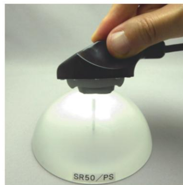
半球試験体の欠陥検出例 (欠陥形状:Φ2平底穴)
