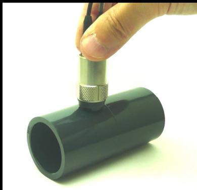
管道厚度测量示例  $t = 4\text{mm}$
