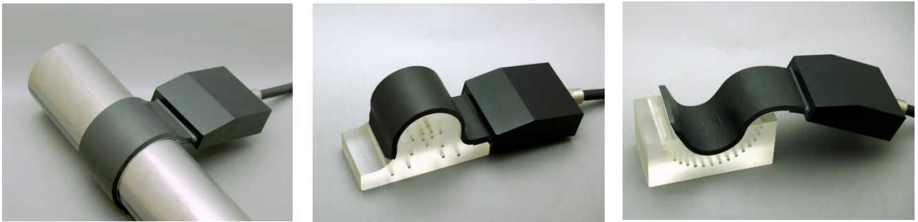
図1 表層欠陥の検出が可能な曲がる超音波アレイプローブ「曲探」の外観
