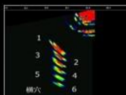
近接欠陥画像例 (横穴Φ1mm間隔0.1mm)
