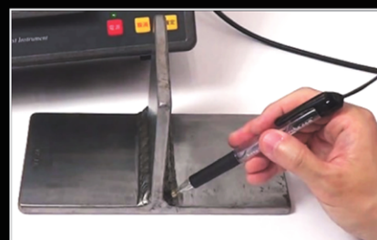
隅肉溶接検査
