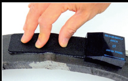
溶接ビード検査
