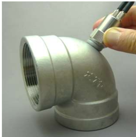
엘보우배관의 두께 측정
