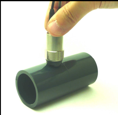
배관의 두께 측정 예 t = 4\text{mm}
