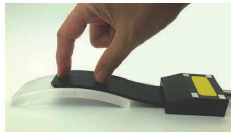
曲面アクリル試験片 欠陥検出風景
