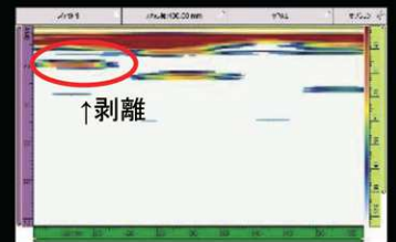
CFRP表面下2mm 剥離検出例
