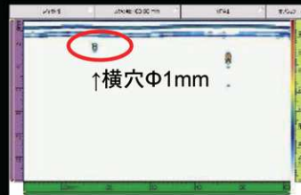
鋼表面下1.5mmΦ1mm 欠陥検出例
