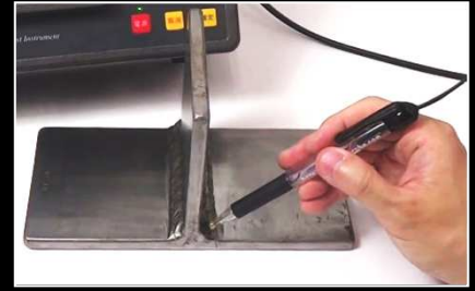
隅肉溶接検査
