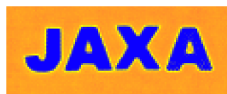
空中超音波での 非接触測定結果画像 (C-Scope)
