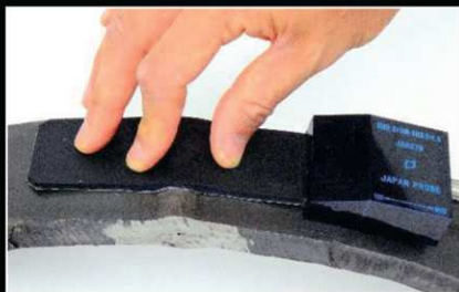
突合せ溶接検査
