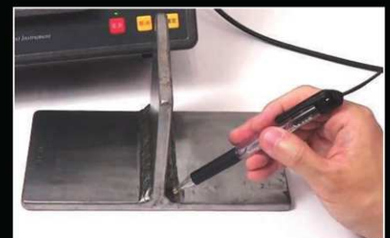
隅肉溶接検査
