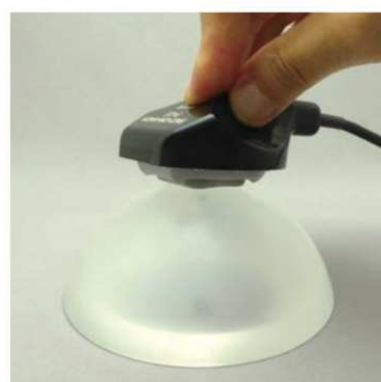
球面試験体の欠陥検出例（欠陥形状:三角形平底穴）
