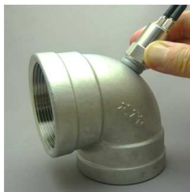
エルボ配管の 肉厚測定
