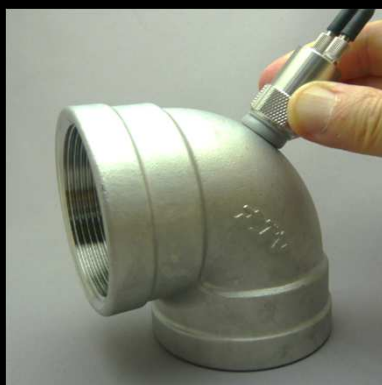
エルボ配管の肉厚検査例
