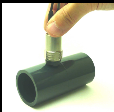
配管の肉厚測定例 t = 4\text{mm}
